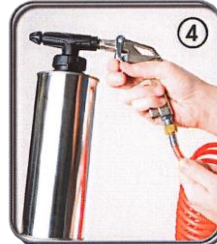
④ エアーコンプレッサーのホースを装着してください。
